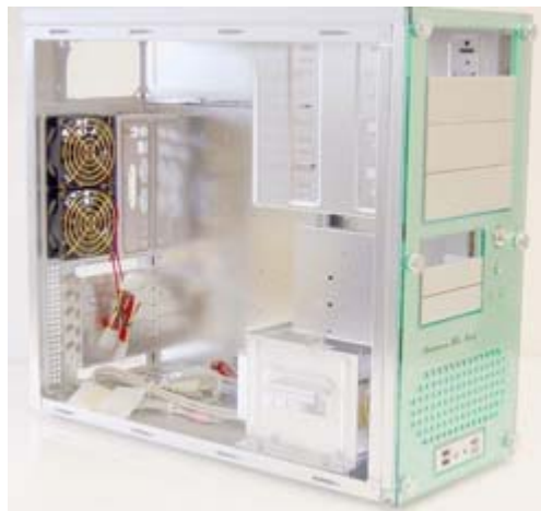
Khi lắp vào Case cần lưu ý các chân ốc bắt Mainboard
